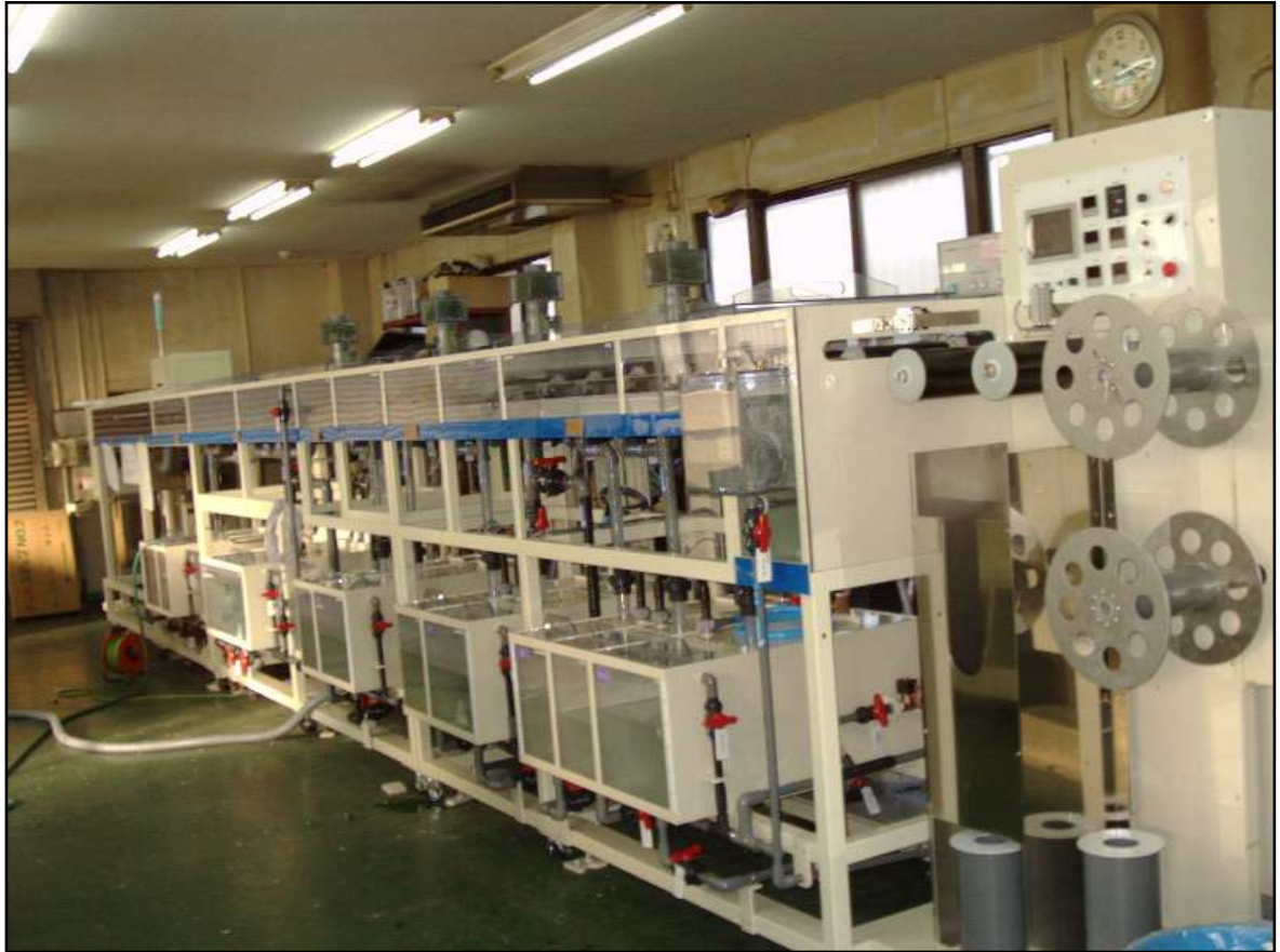
【 図 】 Reel to Reel 無電解銅鍍金装置(250W対応)
